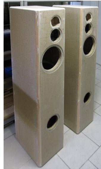
Der Rohbau ist fertig verleimt
